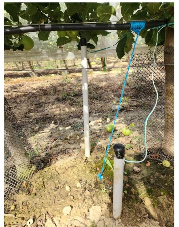
Photographie de tensiomètres installés à 30 cm et 60 cm de profondeur, avec un fil fixé au sol permettant d'orienter la goutte issue de la gaine d'irrigation.
