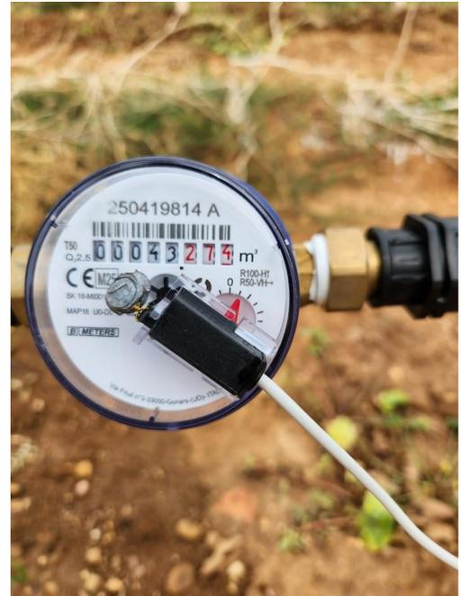
Photographie d'un compteur d'eau connecté
